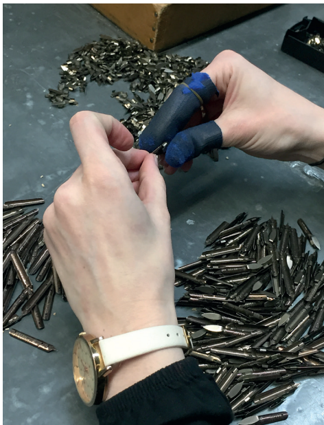
Das Tintenreservoir wird händisch aufgesteckt.
